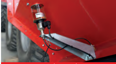
SISTEMA DE LUBRICACIÓN AUTOMÁTICO
