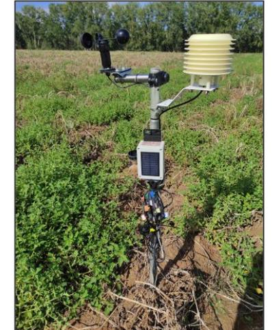
Nodo equipado con pluviómetro, sondas de humedad, anemómetro y unidad H y T
